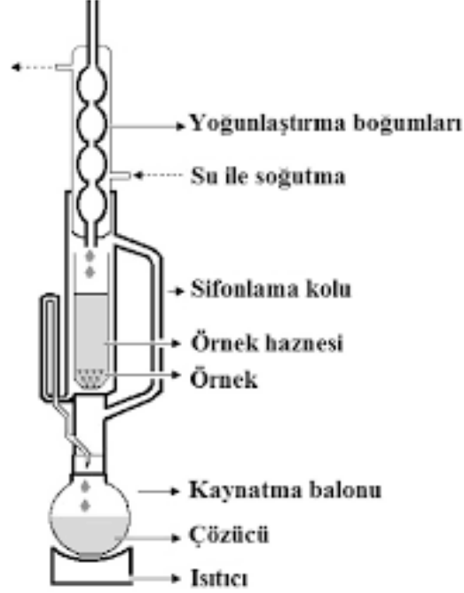
Şekil 1. Soxhlet ekstraktörü ile katı-sıvı ekstraksiyonu deney düzeneği
